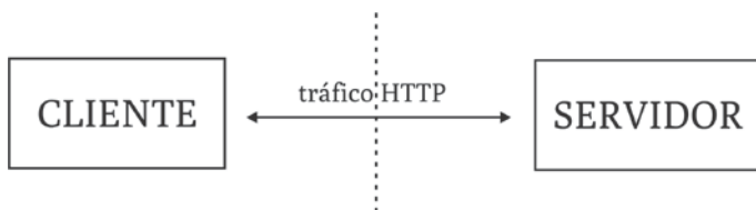
Figura 1.1: HTTP es un protocolo cliente-servidor
